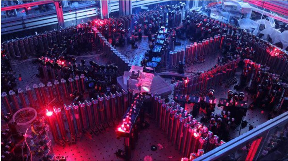
注：左下方为输入光学部分，右下方为锁相光路，上方共输出 100 个光学模式，分别通过低损耗单模光纤与 100 超导单光子探测器连接。
